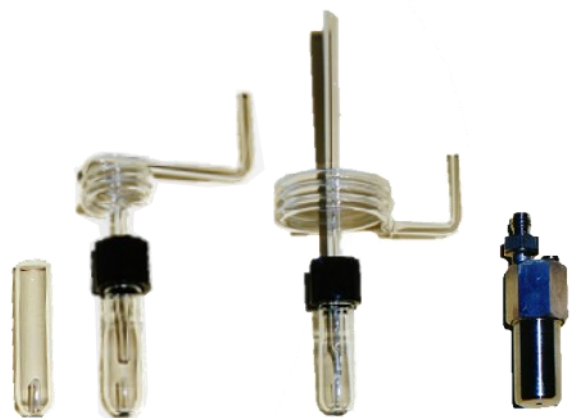
Bild 2: RADEX Glas offen / Inertisierung / Gasmessung / Autoklav
