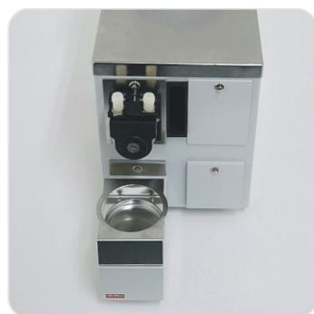
FlexyCUBE mit einer Pumpe und einer Waage für gravimetrische Dosierung
