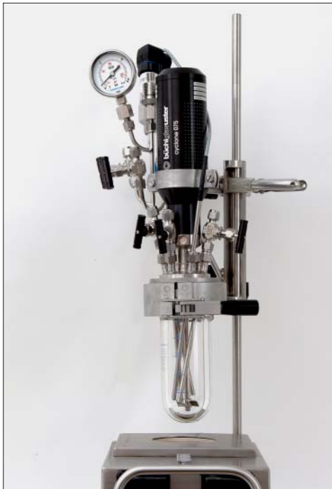
Bild 2 Druckreaktor aus Glas bis 6 bar mit Schnell- spannverschluss
