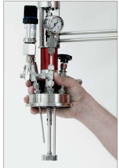
Bild 3 Ansicht von Temperaturfühler (schräg), Ein- lass- oder Probenahmerohr und Rührer
