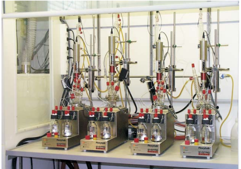
4-fach FlexyLab Fast Track mit 100 ml Reaktoren und 4 Lasentec-Partikel-Analyzer Sonden
