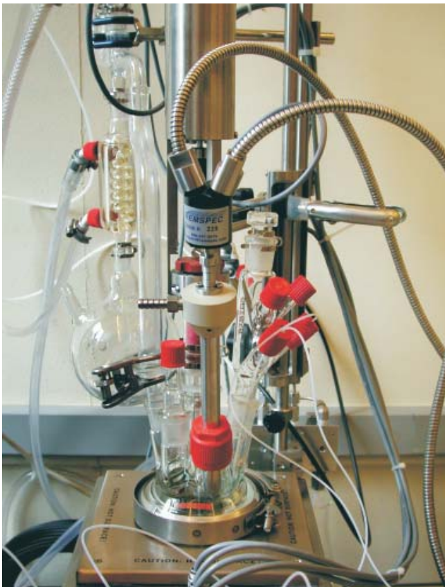
Reaktor mit mid-IR Fiber-Optik, Mehrfachdosierung und Vakuum-Destillation mit Reflux-Teiler
