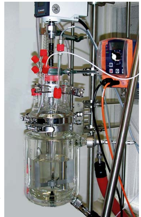
Mögliche Ausführung eines 2l ALR mit Doppelmantel-Reaktor
