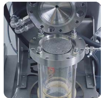
Filterboden mit darunter liegendem Filter. Bequeme Montage bei gedrehter Nutsche
